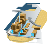
Hamburg Sonderabfallverbrennungsanlage, chemisch-physikalische Behandlungsanlage, Separationsanlage für Öl-/Wasser-Gemische
